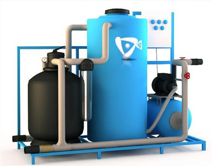
В комплектацию УФОС-2 входит погружной насос, напорный фильтр, кварцевая загрузка (75 кг), фильтр тонкой очистки, накопительная емкость, автоматическая насосная станция и шкаф управления.
